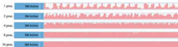
図 2 単一 GPU 上で最大 16 プロセスを実行した場合、MPS によってコア利用率が 100%まで上昇する様子 (NVIDIA Nsight Systems によるモニタ)
