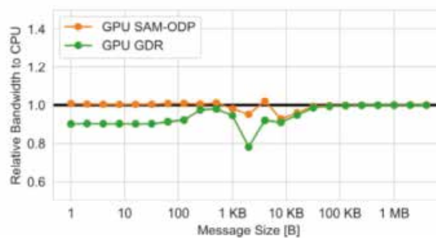
図 27 SAM+ODP と cudaMalloc+GDR の MPI 性能比較
