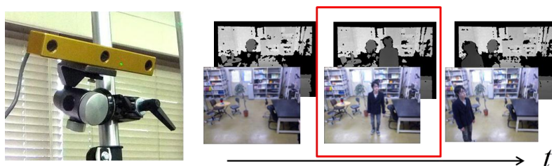
図 7：環境デプスカメラを用いた時系列データベースの取得
