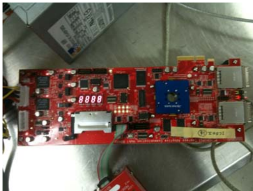
PEACH チップフロアプラン PEACH チップを搭載した PCI-Express テストボード
